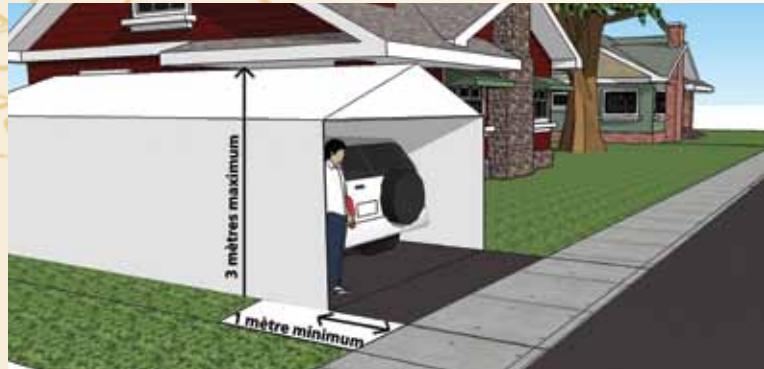
Distance minimale entre l'abri et le trottoir
