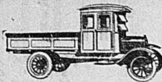
Carrosserie d'express à plateforme avec cab fermé pour le camionnage, messagerie, marchands de gros et livraison générale.
