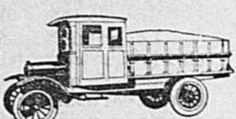
Carrosserie de ferme pour toutes fines : transport de grain, des pro- duits, du foin, du fumier, etc.
