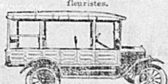
Carrosserie auto-basculante pour le trans- port des passagers sur la ferme, pouvant être transformée en carross- erie à marchandises et d'express.
