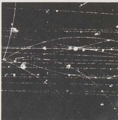
Divers appareils sont utilisés pour étudier les particules. Ainsi au Centre européen pour la recherche nucléaire, on utilise entre autres une chambre à bulles pour observer les collisions de particules.
