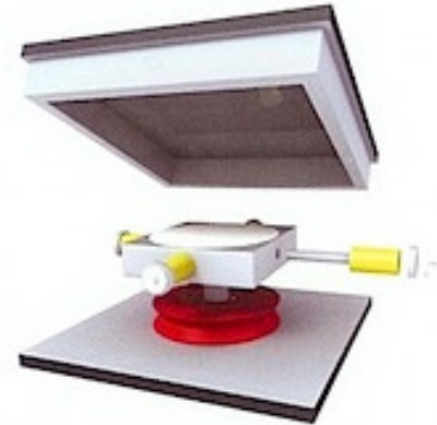
Figure 6.12-9 Isolateur avec un appui à disque et ressorts en élastomère
