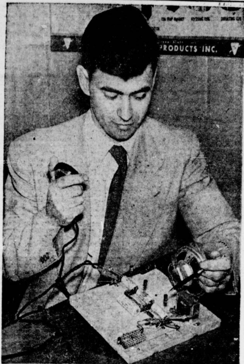
L'appareil que manipule ci-haut M. Gérard Bourgault, directeur des études à l'Institut Teccart, s'appelle transistor et est destiné à remplacer les lampes d'amplification en télévision et radiophonie. On en verra des expériences à l'exposition d'orientation qui s'ouvrira mercredi prochain au Palais du Commerce.
