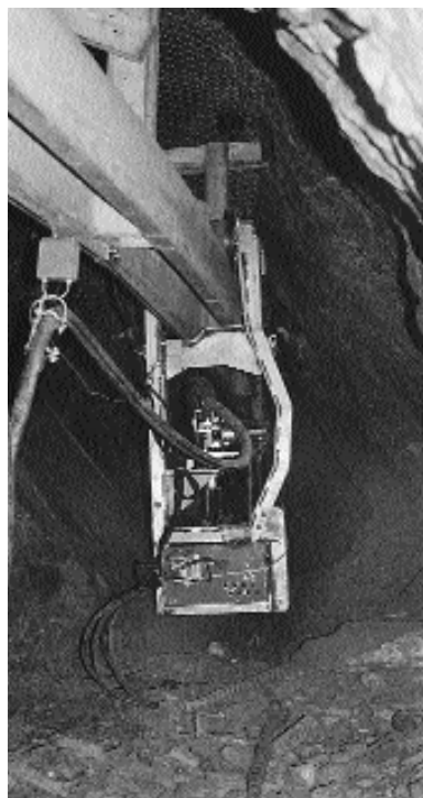
Avec ses quatre roues mues par autant de moteurs, le robot arroseur circule sur des échafaudages et c'est lui qui « prend les risques ».
