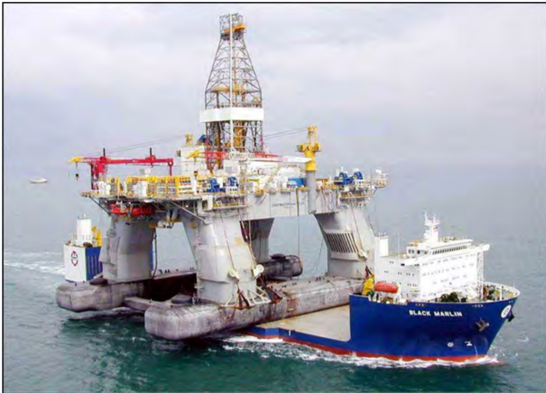
Figure 31 Transport d'une plateforme de forage semi-submersible jusqu'à un site de forage en milieu extracôtier (2b1stconsulting, 2013)
