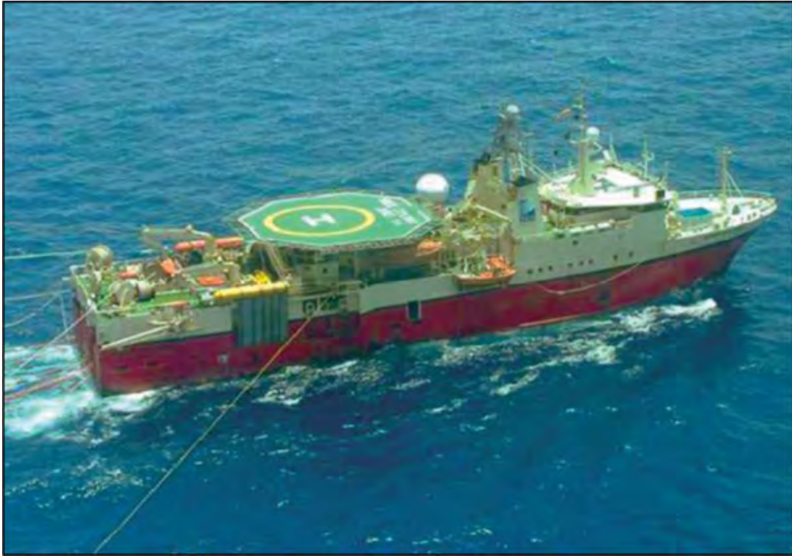
Figure 27 Navire sismique Nordic Explorer utilisé pour la réalisation de levés sismiques (AMEC, 2009)
