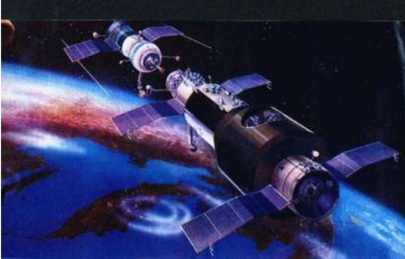
Un vaisseau Soyouz (à l'arrière-plan) sur le point de s'arrimer à la station Saliout, de la taille d'un wagon de chemin de fer. Les «ailes» sont des panneaux solaires générant l'électricité de bord.
