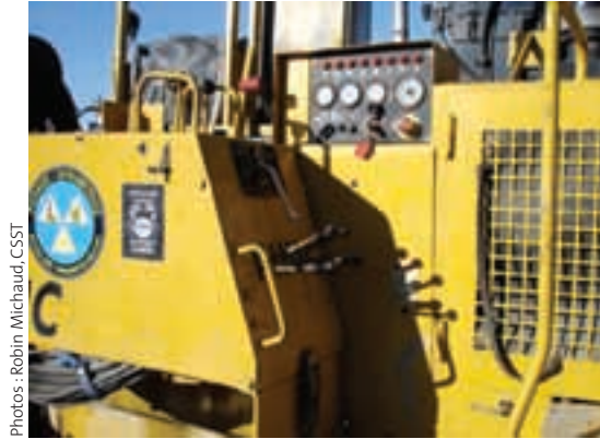
Console principale avec bouton du système d'arrêt d'urgence.
