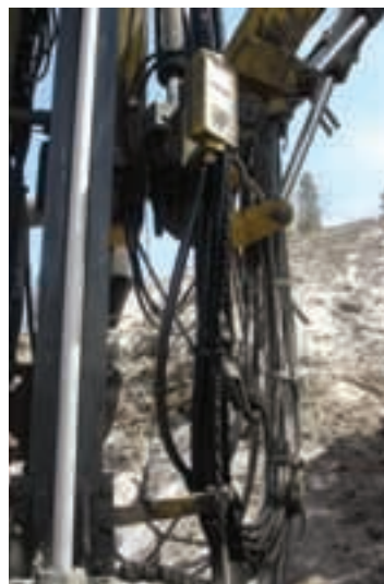
Système d'arrêt par câble sur le mât de forage.
