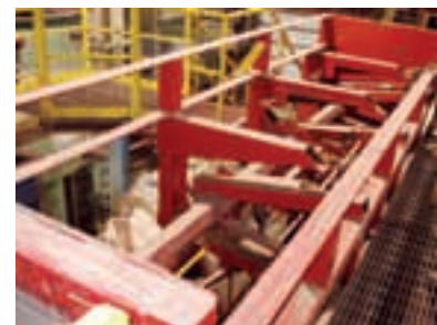
L'ajout de barres dans le broyeur ne nécessite plus que deux travailleurs, maintenant mieux protégés.
