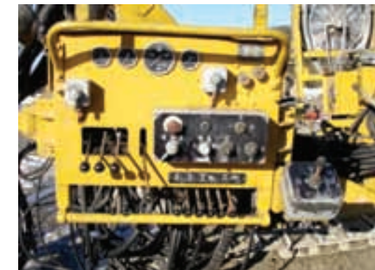
Panneau de contrôle amovible avec bouton du système d'arrêt d'urgence.
