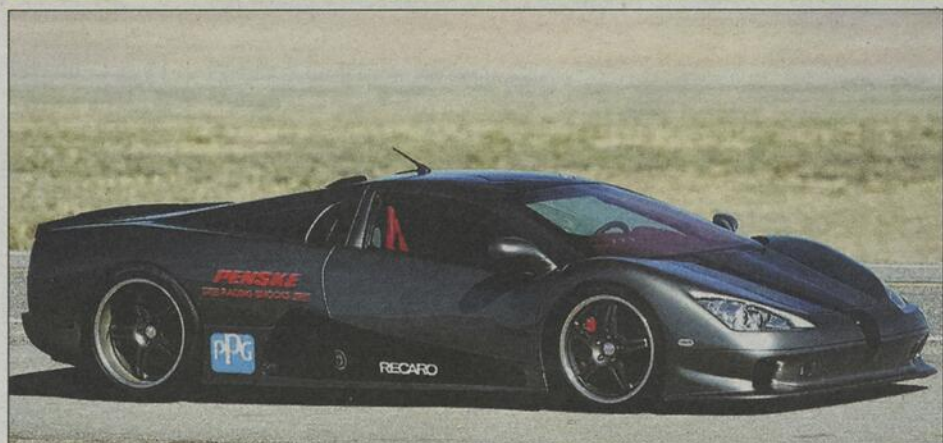
Bien avant que la Bugatti Veyron ne ravisse son titre, la SSC Ultimate Aero a détenu le record de vitesse avec une pointe de 412 km/h. Son moteur est un V8 biturbo de 6,3 litres qui développe 1183 chevaux.
