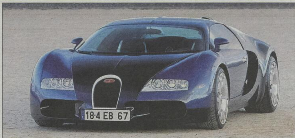
La Bugatti Veyron 16.4 Super Sport se caractérise par son moteur W16 et ses quatre turbos pour une puissance de 1200 chevaux. La vitesse a été bridée par le constructeur à 415 km/h afin de protéger les pneus qui pourraient fondre et éclater au-delà de cette vitesse!
