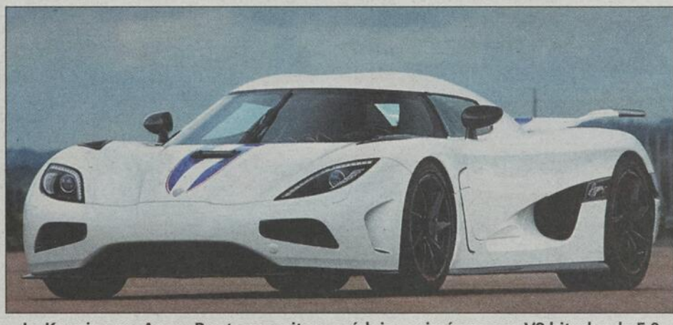
La Koenigsegg Agera R est une voiture suédoise animée par un V8 biturbo de 5,0 litres qui développe 1099 chevaux. Grâce à son poids plume et son aérodynamisme, elle atteint une vitesse de 418 km/h.
