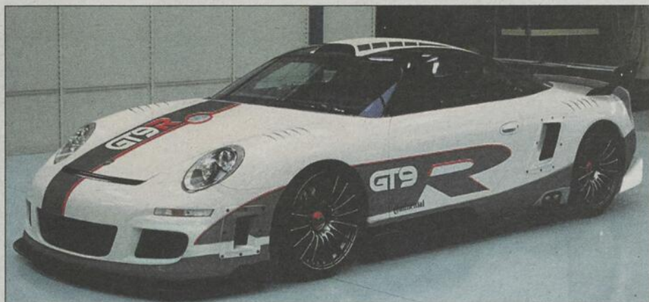
La Porsche 9FF GT9-R a atteint sur circuit une vitesse de 413 km/h grâce à son moteur six-cylindres à plat de 4,0 litres qui développe une puissance de 1120 chevaux.
