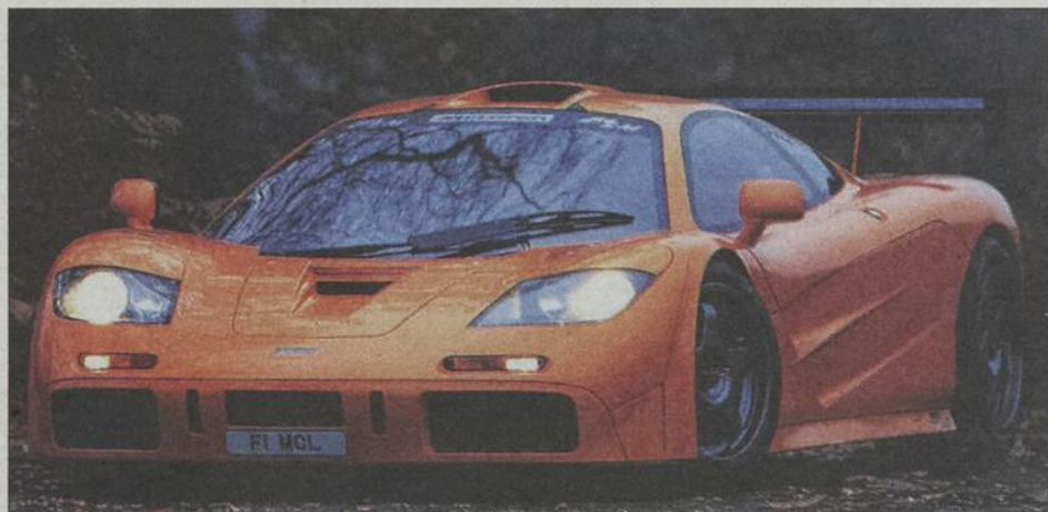
Pendant des années, la McLaren F1 fut la voiture de série la plus rapide avec une vitesse de pointe officielle de 386 km/h. Le moteur est un V12 de 6,0 litres et 612 chevaux.
