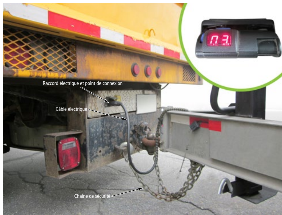
FIGURE 55 (en médaillon) | Contrôle d'intensité pour freins électriques
