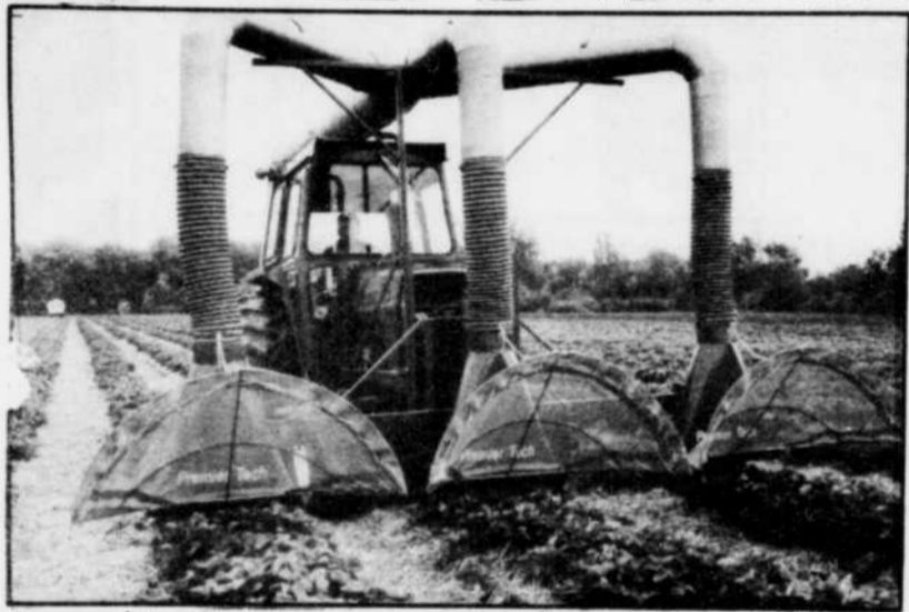
La machine Bio-Vac pour aspirer les insectes nuisibles des champs de fraises, en utilisation chez quelques maraîchers de notre région.
