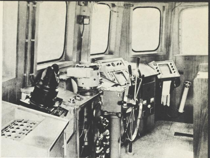
▲ Timonerie moderne. De gauche à droite : Panneau de contrôle du moteur principal Radar Compas magnétique Asdic Echographe En haut : Indicateur d'angle de barre.
