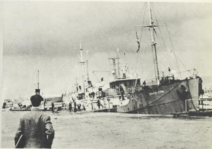
Bateau d'acier de 400 tonnes transformé en chalutier qui pêche par le côté et par l'arrière.
