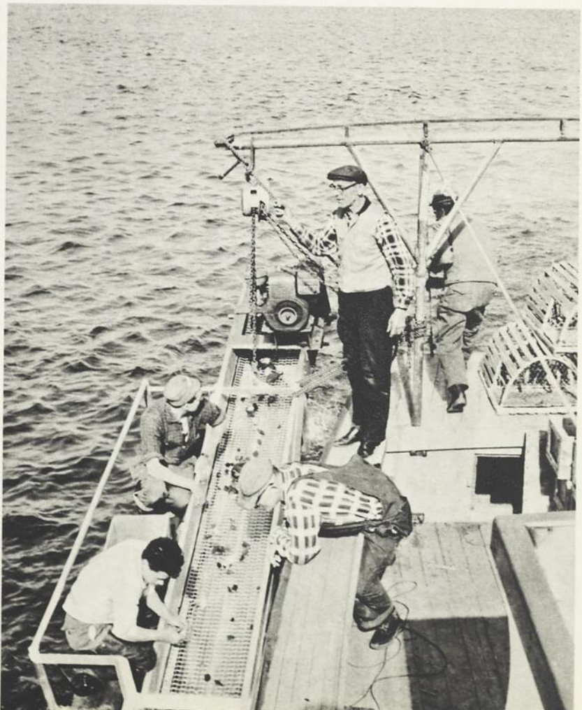
Détail du tapis roulant sur lequel remontent les myes. À l'extrémité supérieure du tapis, le moteur d'entraînement.
