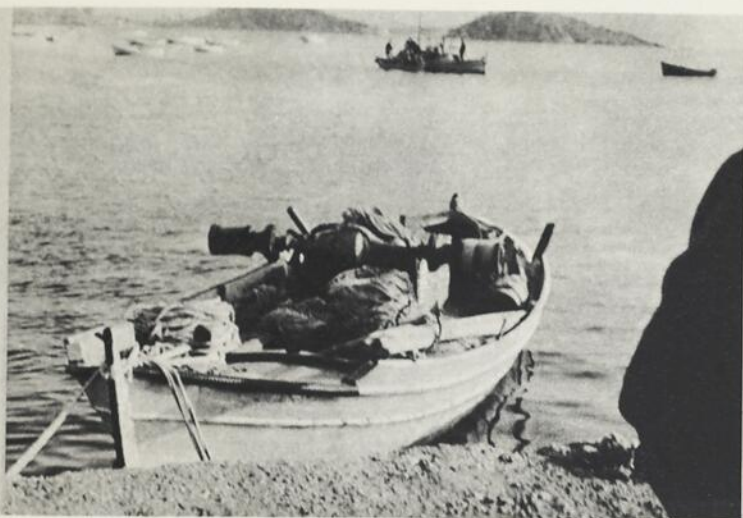
Grèce — Barques équipées d'un treuil pour le lancement du chalut. Elles ne peuvent cependant ni le trainer, ni le relever.
