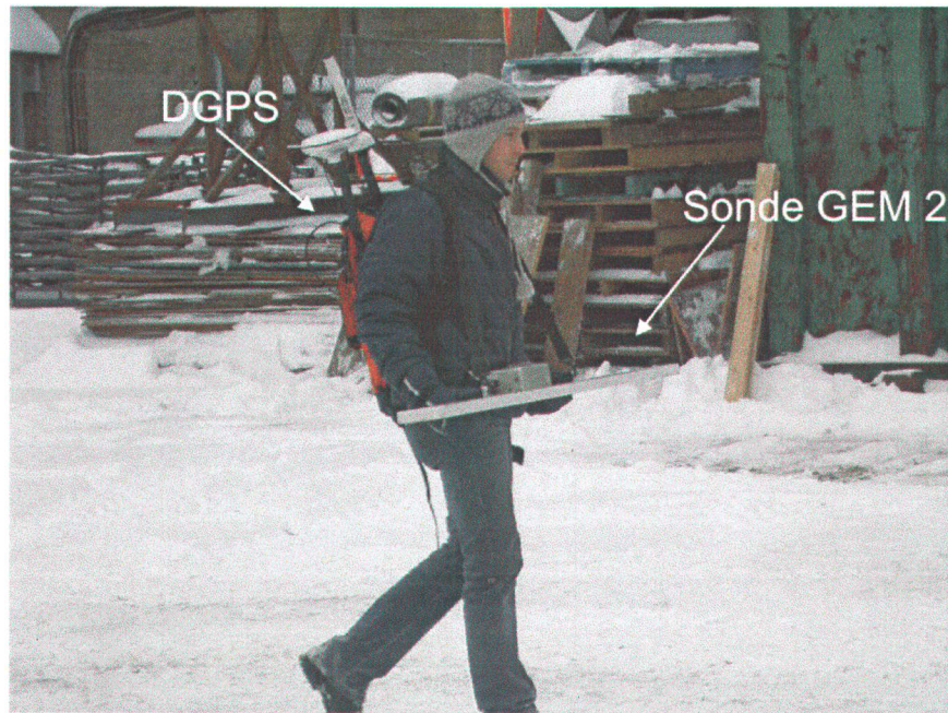
Figure 9. La sonde d'induction électromagnétique GEM-2 multifréquences couplée à un système de positionnement DGPS sub-métrique (photo : quai de la Garde côtière du Canada, Port de Québec). Opérateur : Yves Monette.
