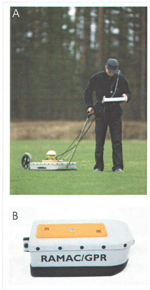
Figure 11. Système Géoradar RAMAC de la compagnie Mala . Le système comporte une antenne blindée, une roue de précision (évaluation des distances) ainsi qu'un moniteur permettant de visualiser les spectres radar en temps réel.
