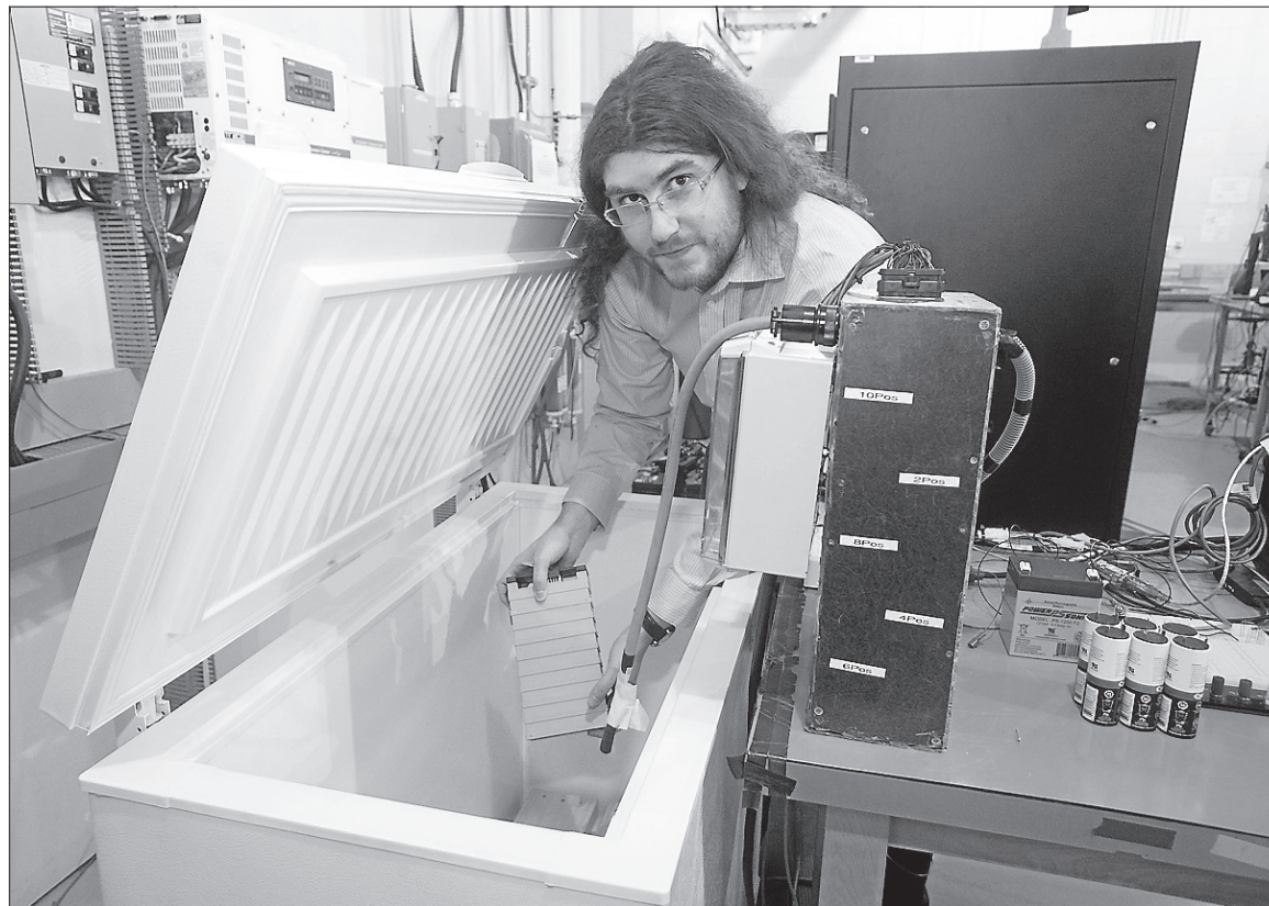
Dans le laboratoire du professeur Loïc Boulon, les batteries sont testées dans un congélateur à température contrôlée.
