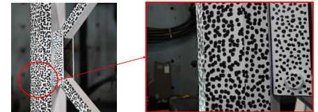
Fig. 10 Flambage local dans la membrure principale
