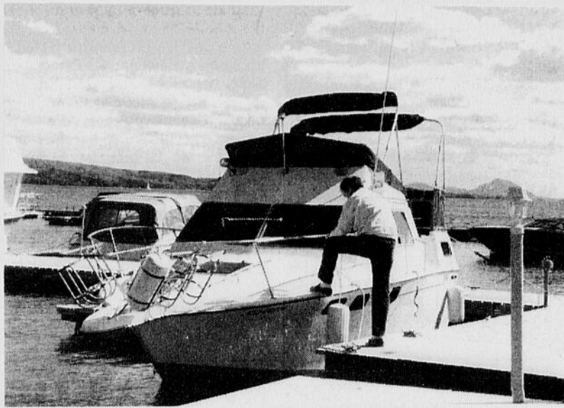
Les propriétaires d'embarcations de plaisance qui fréquentent les lacs Magog et Lovering devront équiper leur bateau d'une installation septique scellée, qui ne pourra être vidée qu'à une station de vidange agréée.
