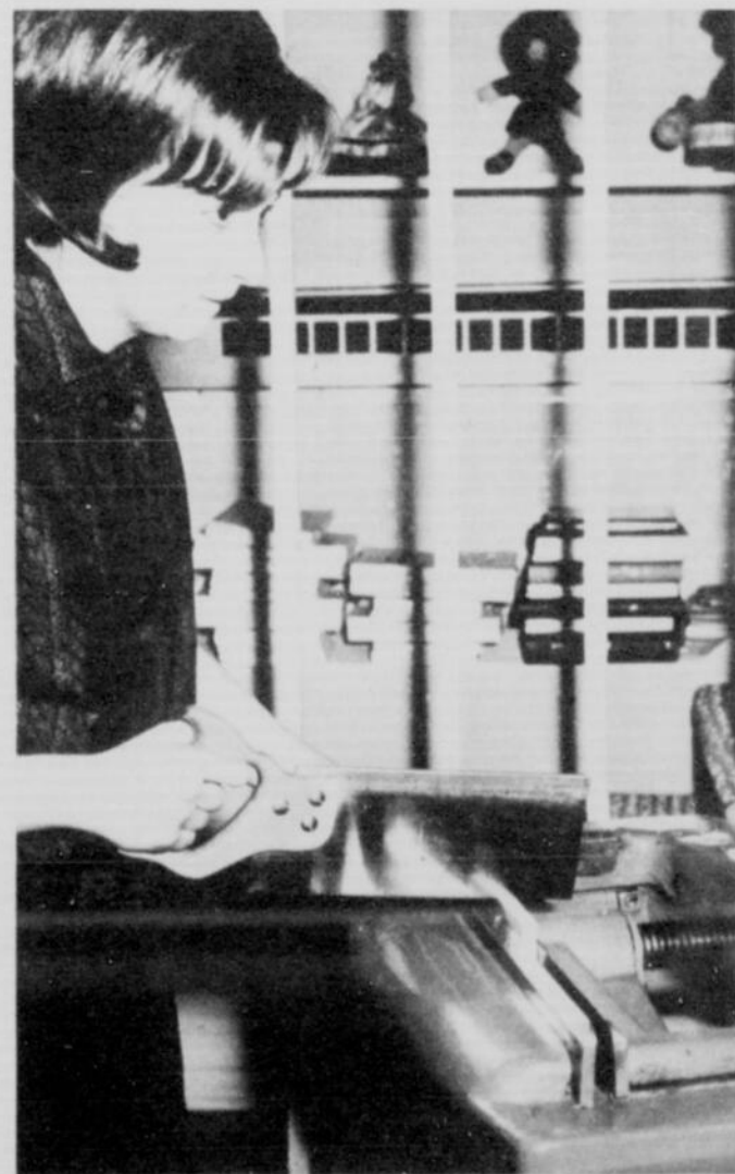
Ici, c'est l'opération dite "grecquage". À la scie, après avoir mis le livre entre les mâchoires du massicot, Mme Grégoire taille les encoches où passeront les ficelles.▷
