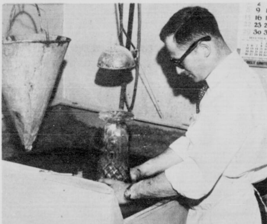
Le dépolissage du cristal se fait au moyen d'une roue d'acier pesant 250 livres, d'eau et de carborundum. C'est un travail très délicat qu'exécute ici M. Markus Baum, propriétaire de l'établissement.
