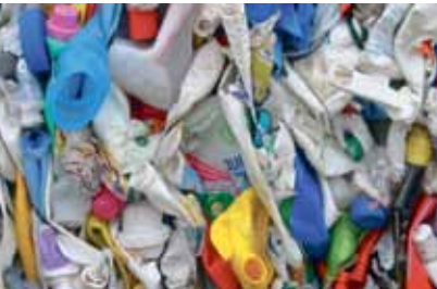
Une fois triées, les matières sont compressées en ballots d'une tonne environ. Les matières sont prêtes à être achetées par les industries de recyclage.
