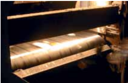
Le plastique est trié par des machines qui reconnaissent optiquement la composition du matériau.
