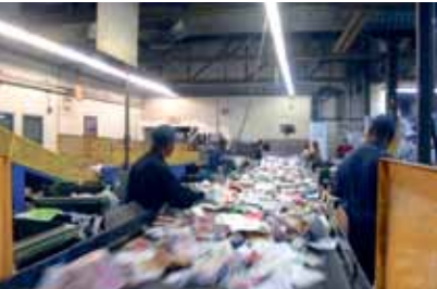
Les trieurs retirent les contaminants (sacs de plastique en majorité) et les papiers mal triés par les machines automatiques qui les précèdent.
