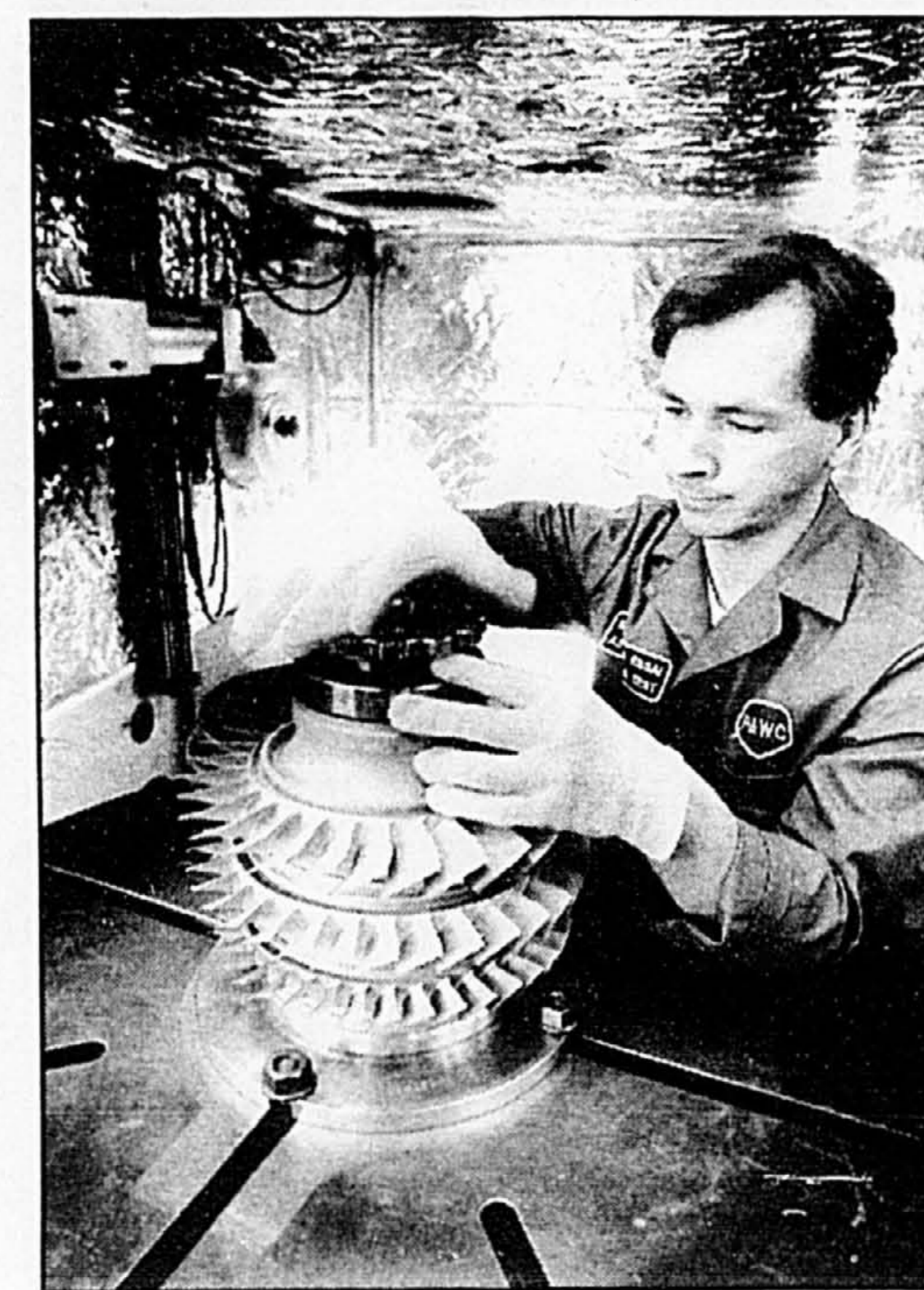
Assemblage d'un compresseur de turbine à gaz.
