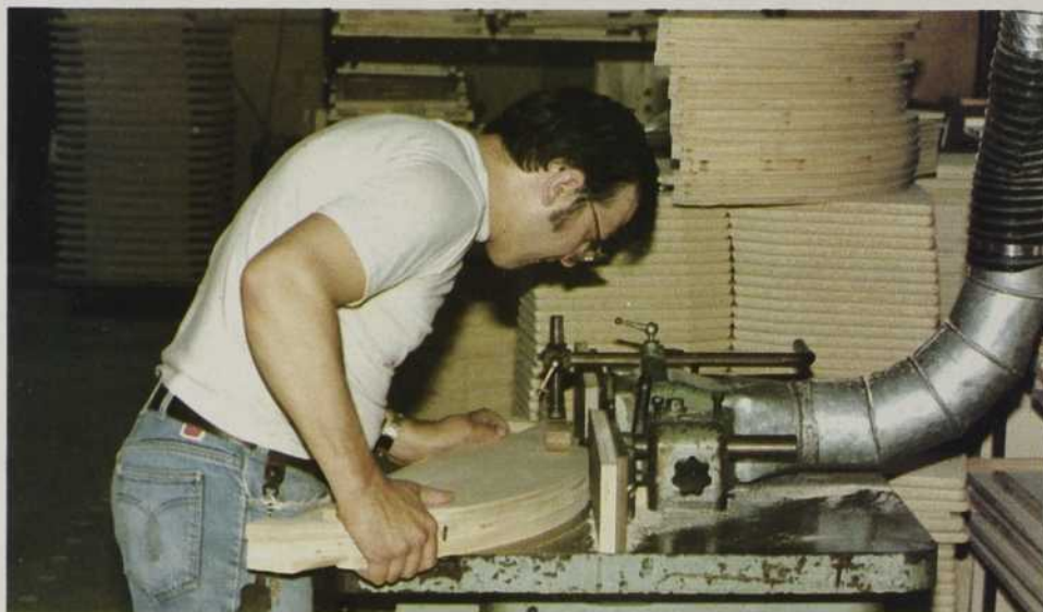
Façonnage à la main des pièces d'enceintes.
