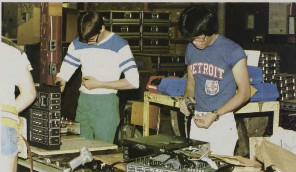
Assemblage final des consoles de mixage vers les tests.
