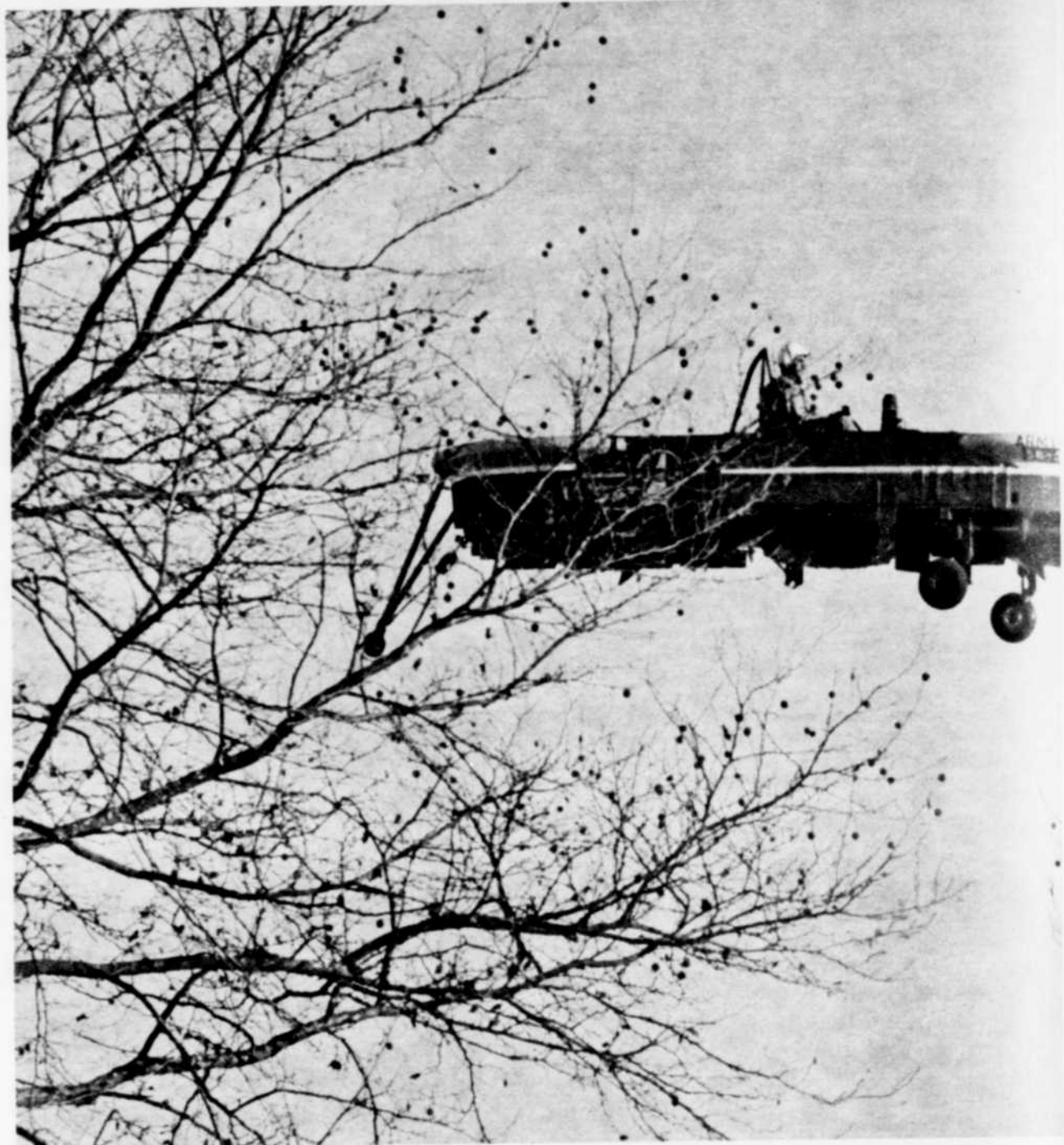
Le Sky-Car de l'armée américaine est si maniable qu'il peut voler entre deux arbres, grâce à ses hélices internes.
