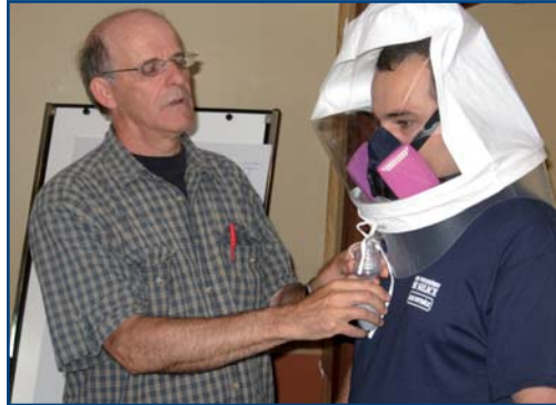
Au cours du test d'ajustement qualitatif, l'utilisateur fait appel à ses sens pour détecter l'infiltration d'une substance odorante ou irritante à l'intérieur du masque.
