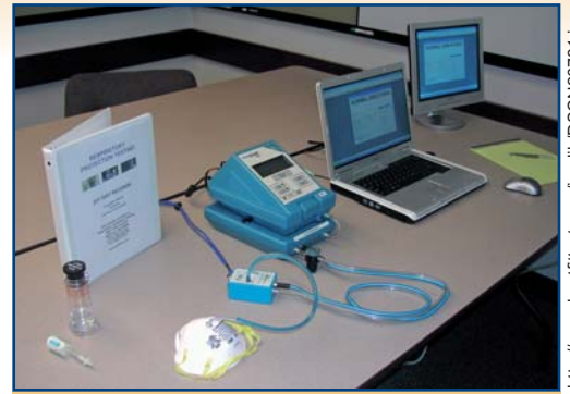
Le compteur de particules permet de mesurer quantitativement l'infiltration de l'agent d'essai à l'intérieur du masque.
