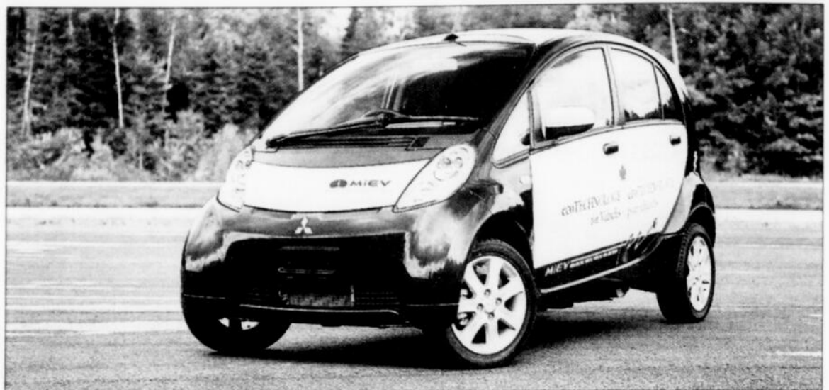
La Mitsubishi i-MiEV a une autonomie d'environ 130 kilomètres, selon le type de conduite, et une vitesse de pointe de 130 km/h. (Cortoisie)
