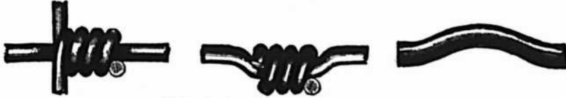
Joint de charnière et courbes de tension.
