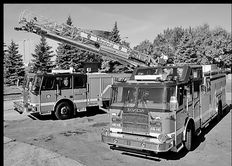
PHOTO IVANOVAH DEMERS, LA PRESSE © Nouvelle échelle aérienne munie d'une colonne d'eau avec canon et dotée d'un système de mousse et d'un espace pour le matériel de premier répondant. 2007.
