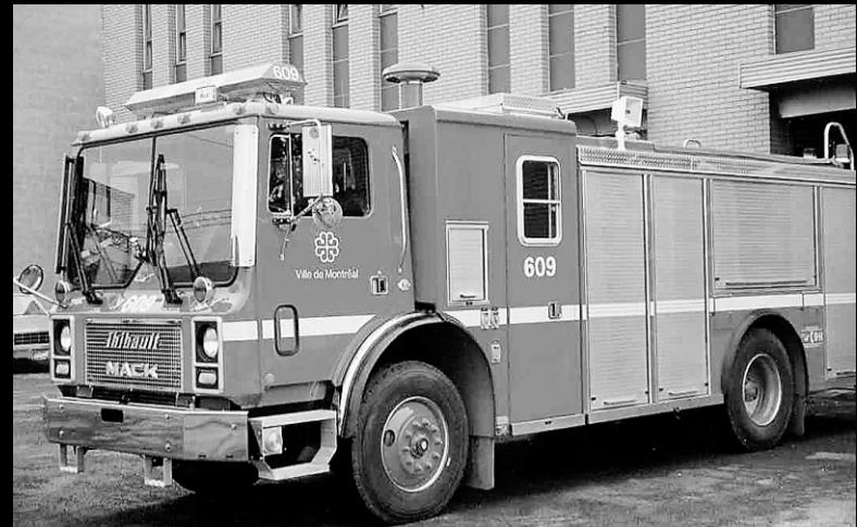
PHOTO FOURNIE PAR PIERRE GASCON HISTORIEN ET ARCHIVISTE DU SIM L'année 1991 marque la mise en service de 11 autopompes multifonctionnelles à deux réservoirs, un pour l'eau, un second pour la mousse, des outils et des pinces de décarcation.
