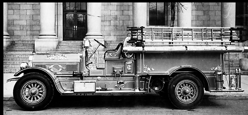
PHOTO ARCHIVES LA PRESSE © Autopompe d'une capacité de 4546 litres à la minute. 1925.
