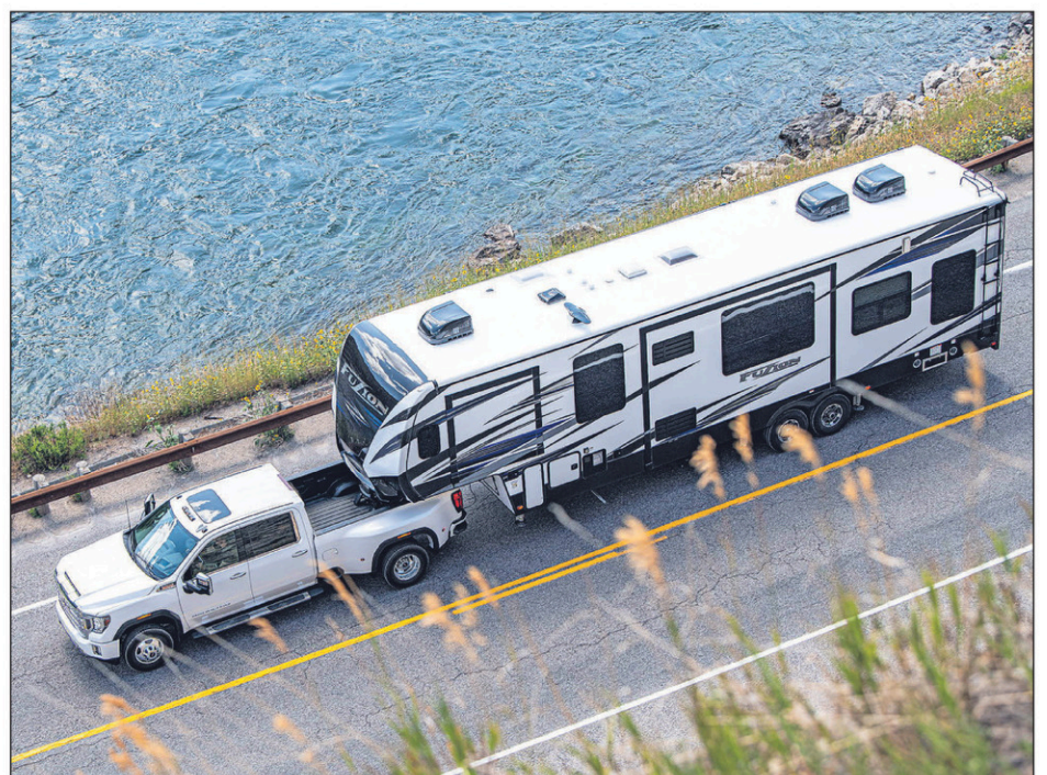
Le système d'attache à sellette ou cinquième roue ( fifth wheel ) améliore la stabilité du convoi et augmente la capacité de remorquage de la camionnette.
