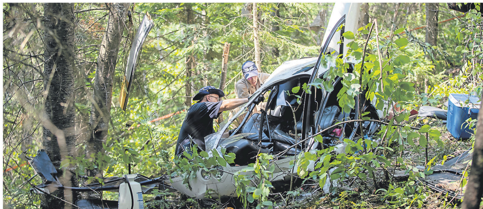
Les enquêteurs du BST sur les lieux de l'écrasement de l'hélicoptère du président de Savoura, Stéphane Roy. L'organisme affirme que le rotor principal et le rotor de queue «ne montraient pas les signes caractéristiques d'un impact alors que les rotors tournent à pleine vitesse». — PHOTOTHÈQUE LE SOLEIL
