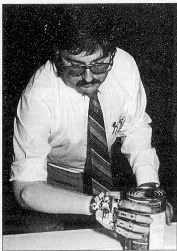
La main multifonctionnelle se rapproche de la main naturelle avec ses doigts qui sont tous articulés.
