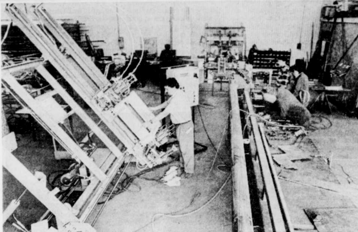
M. Réal Perreault, actionnaire et ingénieur mécanique à l'usine de Cadoret, examine une machine à assembler des cadres fabriquée par la compagnie de Saint-Augustin.
