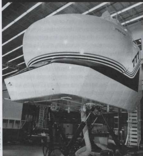
FIGURE 2 Vue extérieure d'un simulateur de vol de Boeing 777
