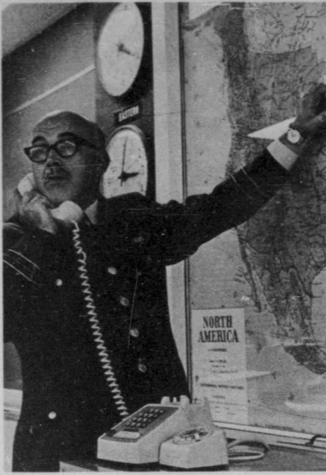
Le major E.G. Riley des Forces armées du Canada utilise le nouveau téléphone à 16 touches, conçu spécialement pour un système de communications de défense ultra-perfectionné — soit le réseau canadien de transmission par commutation électronique — que construit actuellement le Réseau Téléphonique Transcanadien à l'intention des Forces armées. Le "cercueil" de ce réseau est constitué de neuf centraux électroniques répartis à travers le pays.
