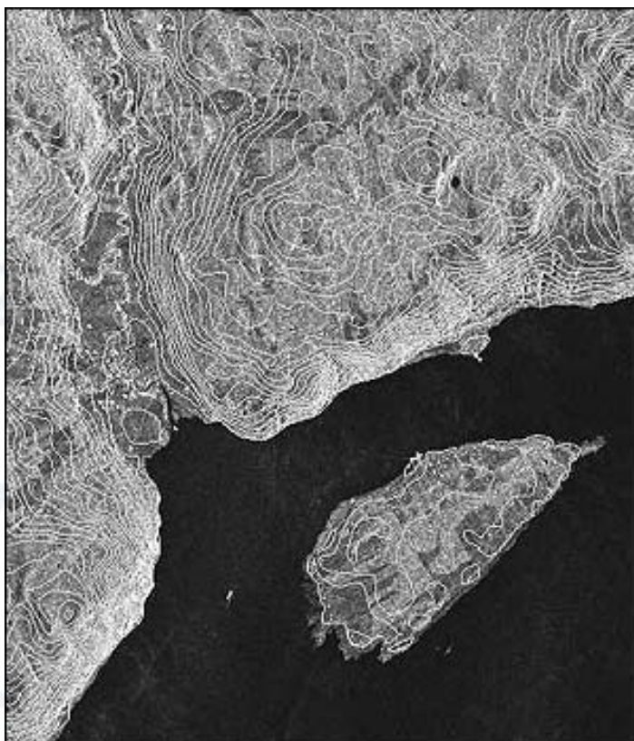
Les courbes de niveau obtenues par radargrammétrie dans la région de Baie-Saint-Paul (secteur de Québec) sont superposées à l'image RADARSAT, à gauche, et sur la BDTA, à droite.
