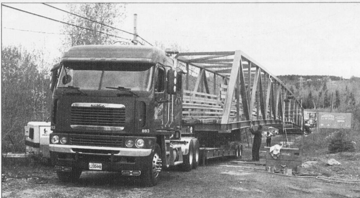
LIVRAISON - La passerelle est arrivée à destination, à Sainte-Monique, où elle a été installée sur ses piliers par les ouvriers de Construction Proco.
