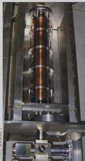
Cœur de la fontaine atomique : une partie de la chambre à vide est faite d'un cylindre de cuivre avec les électrodes de contrôle du champ magnétique. Le tout est dans une boîte qui blinde le champ magnétique.
