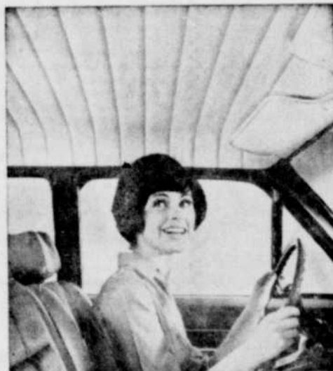
PLAFOND ISOLÉ C'est une caractéristique standard de la Classic et de l'Ambassador. L'isolant de fibre de verre protège contre le froid en hiver et contre la chaleur en été. Il réduit aussi le bruit dans une proportion de 30%.
