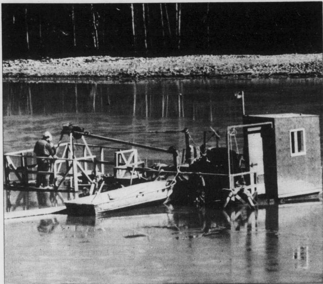
Une pompe flottante automotrice, invention de la mine Doyon, permet de récupérer les boues et de les entreposer.
