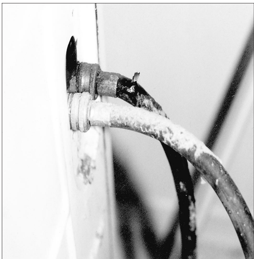
Les tuyaux ne doivent pas être mis sous pression constante.
