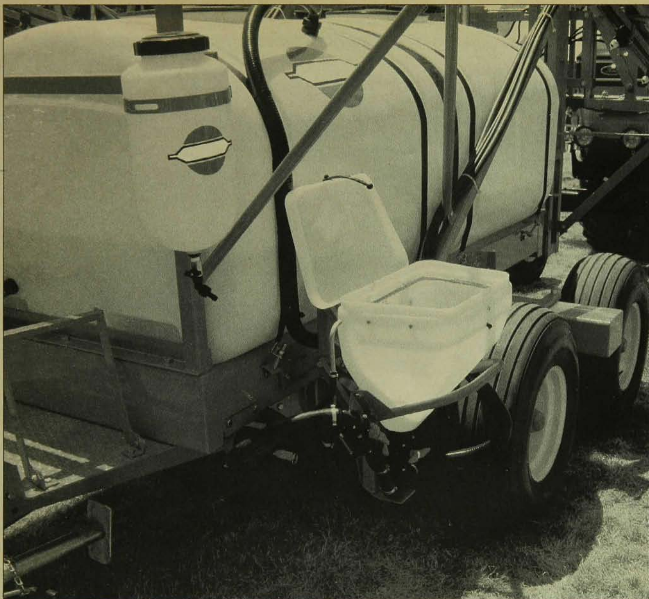
La cuve auxiliaire facilite le déversement des phytoprotectants et le bidon rempli d'eau sert à se laver les mains après chaque intervention.
