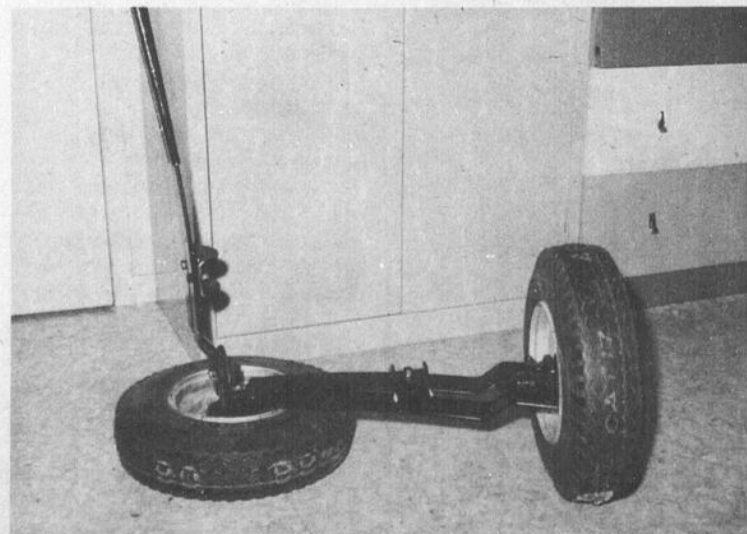
Les roues de la remorque qui installées sur la moto-neige en font un véhicule tout-terrain.
