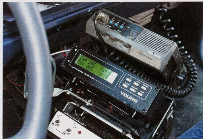
On peut voir l'ordinateur qui saisit les données des capteurs montés sur la camionnette. Il prend en charge également l'affichage de ces données. Il s'agit de l'appareil du centre. Il est noir avec un logo "Young" sur sa façade.
