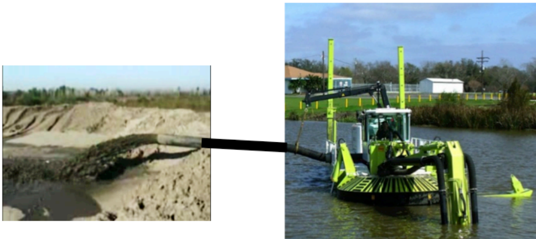
Figure 5.18: Amfibex 400 proposé pour le dragage
