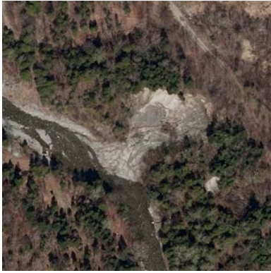
Figure 3.19: Glissement de terrain dans le segment amont de la rivière Bulstrode (ruisseau Gobeil)
