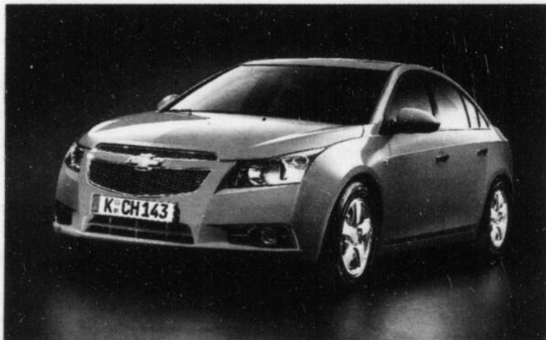
La Chevrolet Cruze, qui remplacera la Chevrolet Cobalt, offrira un moteur quatre-cylindres, de 1,8 litre atmosphérique de 138 chevaux ou de 1,4 litre turbocompressé offrant 140 chevaux.
