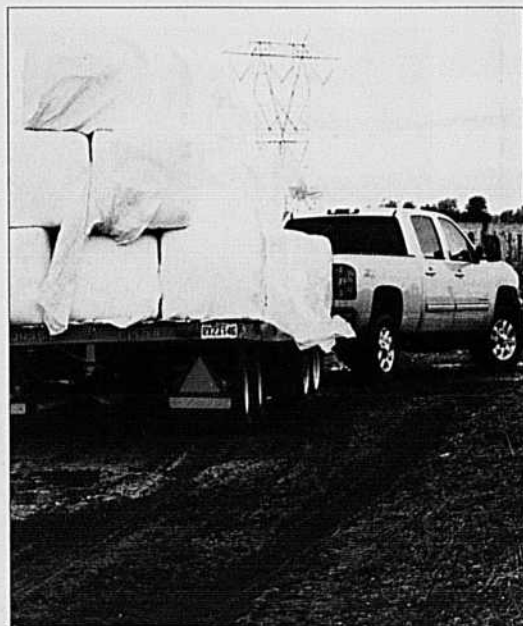
Sur une surface légèrement boueuse, le système quatre-roues motrices et le poids du camion ont permis de tracter cette lourde charge sans problème.
