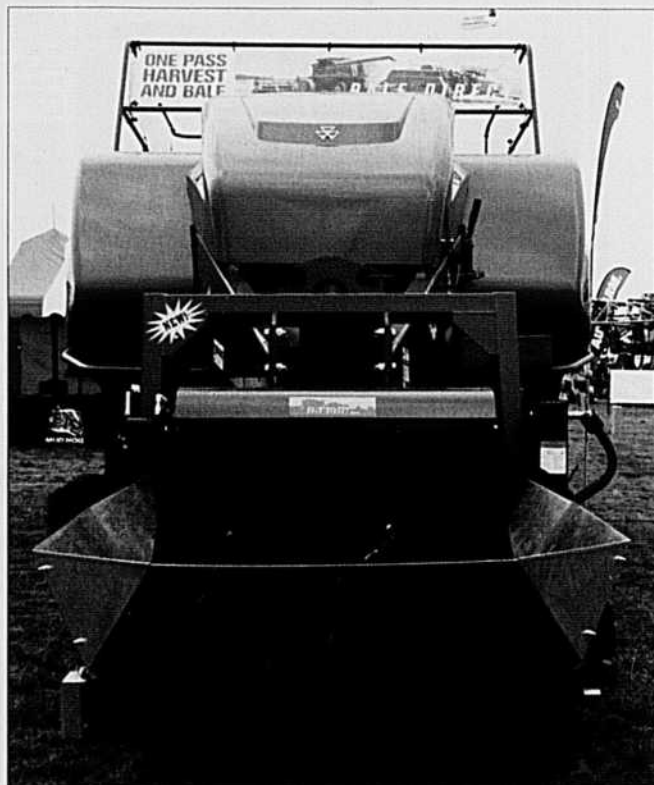
Un convoyeur hydraulique remplace le ramasseur d'andains.
