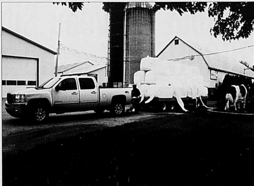
Les 24 balles de foin pesant approximativement 450 kg chacune, en plus de la remorque dont le poids est évalué à 1000 kg par le producteur, ont permis d'effectuer des tests d'accélération impressionnants.
