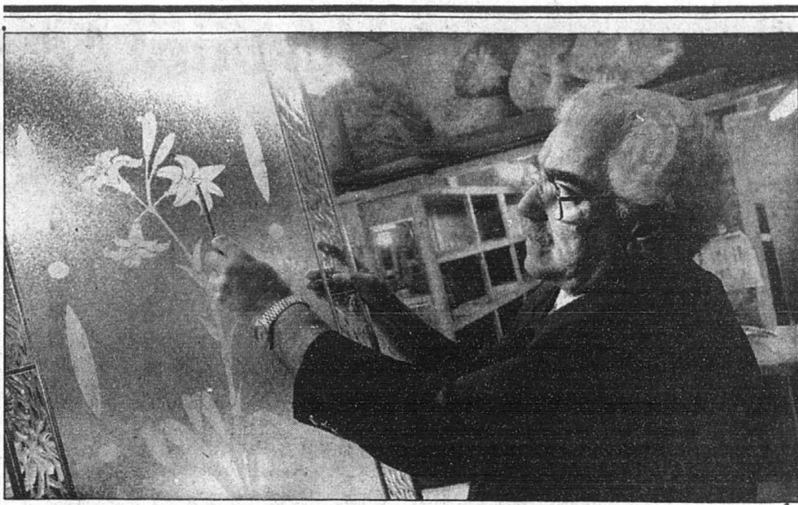
Dans ses locaux de Montréal-Nord, M. Barazin montre la précision que permet la gravure à l'acide fluorhydrique sur ses vitraux.
