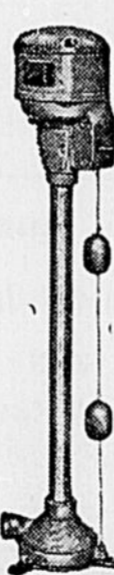
POMPE A PUISARD , pour cave plus profonde que le niveau de l'égout. Capacité de 2,825 gallons à l'heure. Fabriquée de fonte et de cuivre ou tout en cuivre. Prix à compter de $66.25
