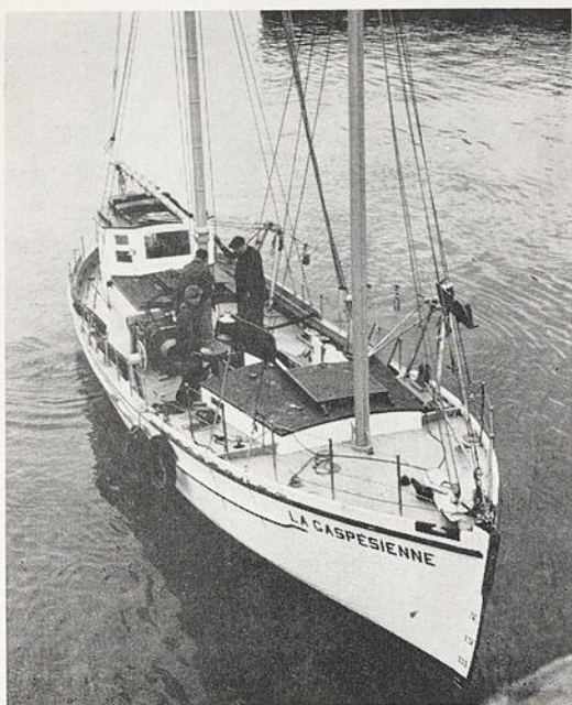
Une "Gaspésienne", version moderne de la barge de Gaspé. C'est un petit cordier (palangrier) de 45 pieds. Capacité: 10 tonnes de poisson.
