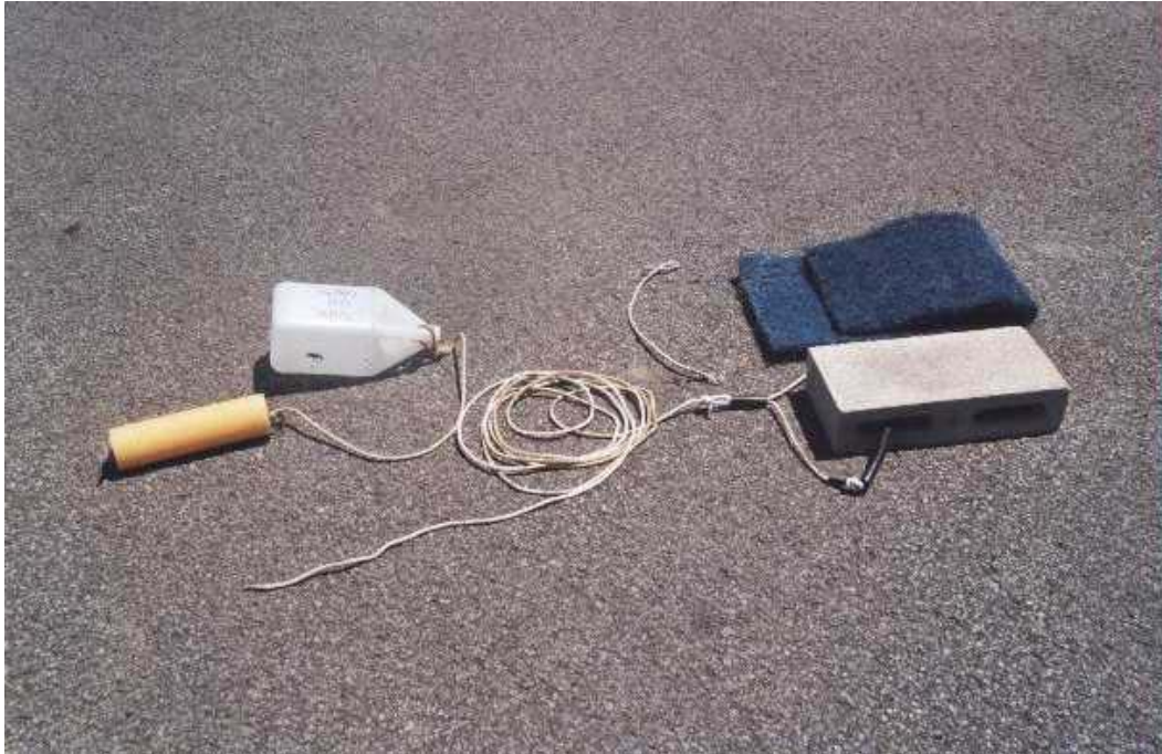
Photo 1. Éléments constituant l'engin de capture utilisé pour la recherche systématique d'oeufs d'esturgeon jaune dans la partie amont des rapides de Lachine, printemps 2002 : parpaing de ciment, pièce de filtre à air, bande élastique à crochet, cordage et bouées.
