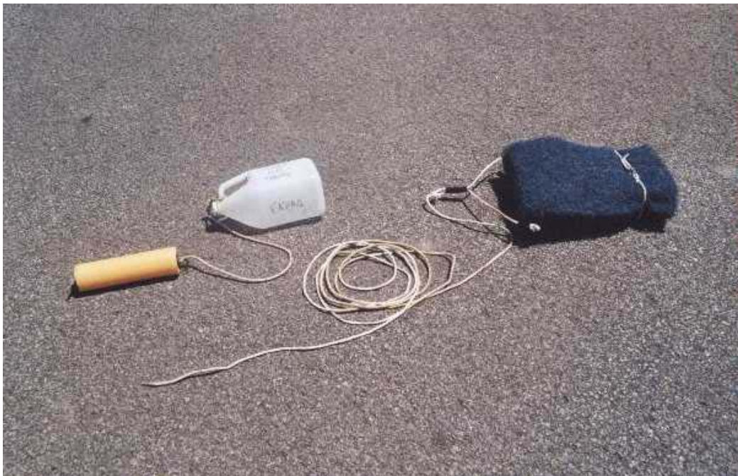
Photo 2. Engin de capture assemblé; le parpaing est recouvert de la pièce de filtre à air qui est maintenue en place au moyen de la bande élastique.
