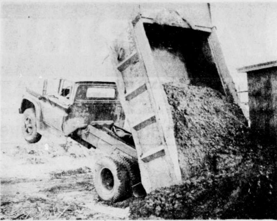
FACHEUSE POSITION. — Un camion qui était affecté au transport de terre pour niveler la partie qui servira de stationnement au nouveau centre d'achats Plaza Granby, s'est retrouvé dans une position plutôt précaire hier après-midi. La porte à l'arrière de la bascule n'a pas opéré et la terre a retenu le camion en se déversant. Il a fallu plus tard utiliser un tracteur muni d'une pelle pour dégager la terre qui plaçait l'avant du véhicule à environ six pieds de terre.
