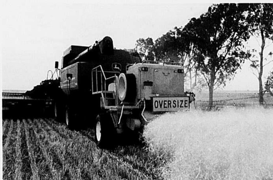
Le Harrington Seed Destructor s'attache à l'arrière de la moissonneuse-battisse. Lors du battage, tous les résidus de culture sont dirigés vers l'équipement pour être broyés finement.
